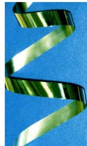
Изготавливаются методом "спиннингования"- выдавливанием струи расплава из тигля через калиброванное сопло на наружную поверхность металлического быстровращающегося диска, от которого после охлаждения со скоростью до 1 млн. °С/сек. отделяется непрерывная лента с заданными шириной и толщиной.
